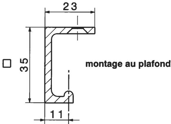
10130 rail de roulement sur mesure
