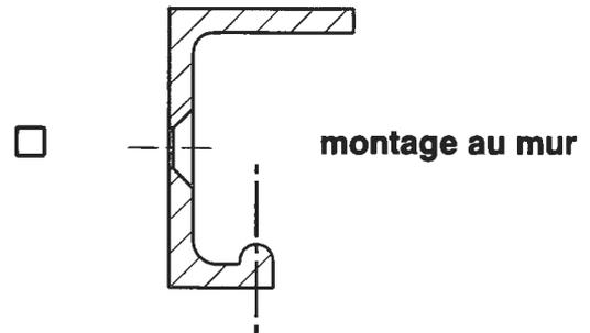
10126 rail de roulement sur mesure
