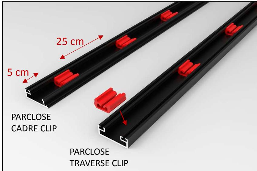
Préconisation de mise en place des clips dans les parcloses cadre et traverse
