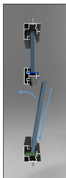
Enfiler le remplissage dans le cadre horizontal haut et le laisser reposer sur les cales
