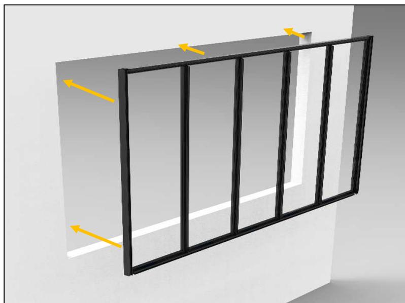
Le support de pose de la verrière doit être de niveau, d'équerre et rectiligne
