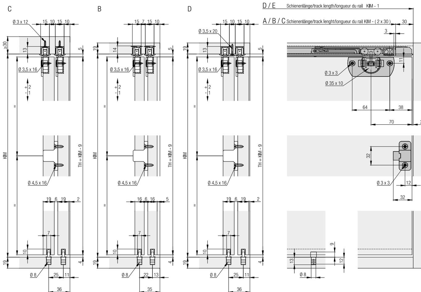
**Garniture pour 2 portes en bois jusqu'à 16 kg, avec réglage en hauteur**
