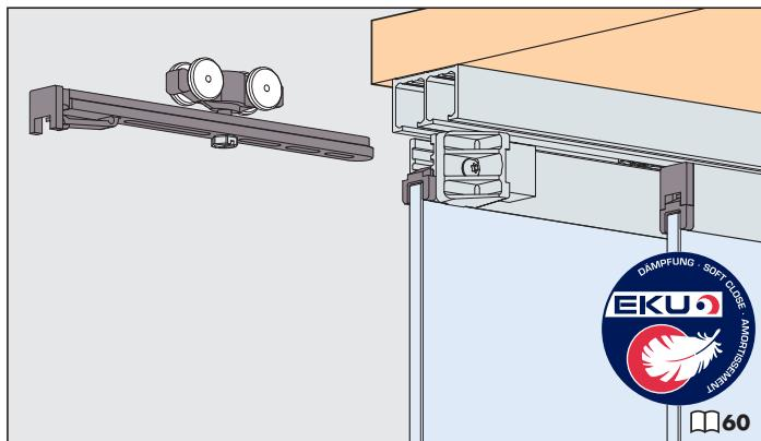
**System: Laufschiene eingenumet oder aufgeschraubt, keine Nut im Boden, ohne Blende, mit verdecktem Clip-Laufwerk, für 2 Glastüren bis 16 kg.**
