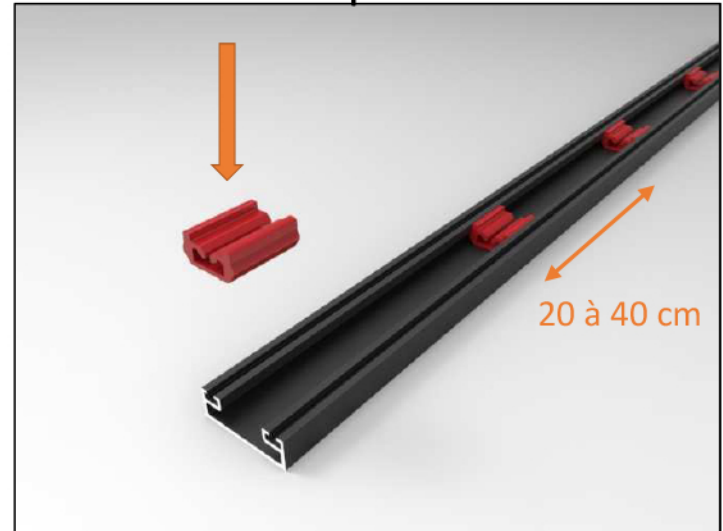
Mise en place des clips sur la parclose
