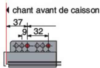
Le positionnement de la coulisse Quadro Push to Open crée un jeu de 4 entre la façade et le caisson pour un bon fonctionnement.
